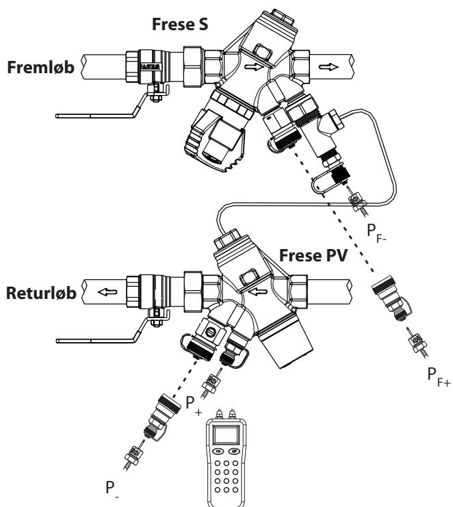
Designflow i strengen: Q indstilles direkte på Frese S (se forindstillingsdiagram)
