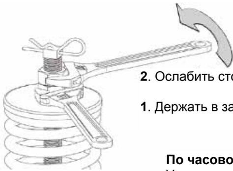
2. Ослабить стопорную гайку в направлении, указанном стрелкой
